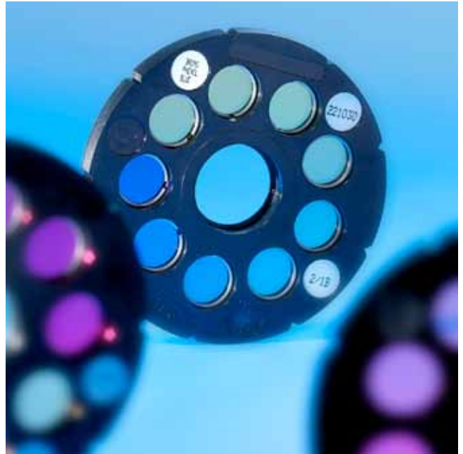
Farbscheiben mit lichtbeständigen Glasfiltern
