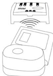
Encoche pour IR transmission de données
