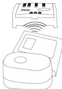
Encoche pour IR transmission de données
